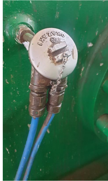
Figure 4.4. Capteur de Température du compresseur
