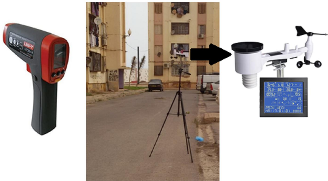
Figure V. 9: les instruments de mesure employés dans la campagne de mesure. À droite la station météorologique FRROGIT modèle WH4000SE WI-FI, à gauche le thermomètre infrarouge modèle UNI-T UT301A. Source : Auteur.
