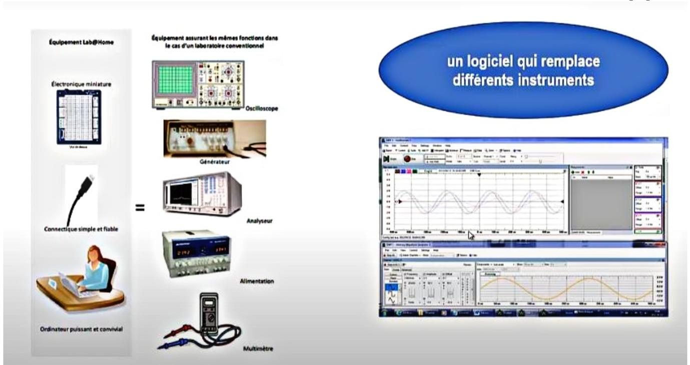
Figure12 : image représentant un logiciel qui remplace différents instruments électroniques[3]
