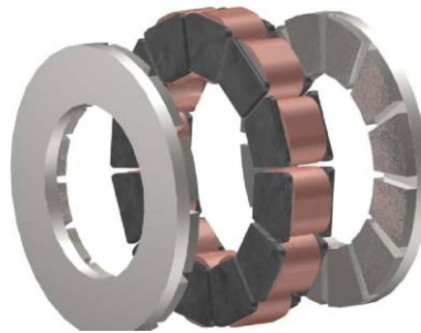
Figure I-12. La structure de la machine à flux axial avec double entrefer.
