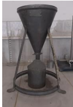
Figure 3 : La masse volumique apparente du ciment.
