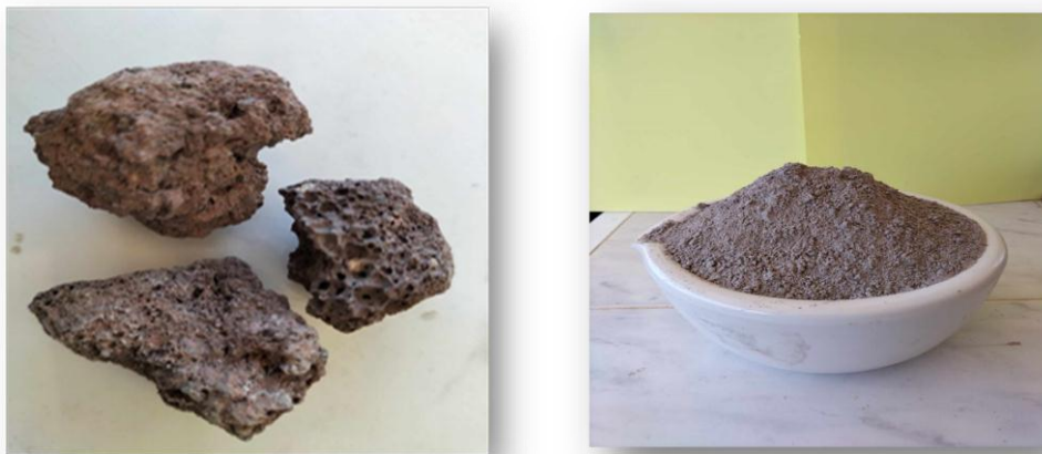
Figure I.5: La pouzzolane naturelle utilisée, avant broyage et après broyage.
