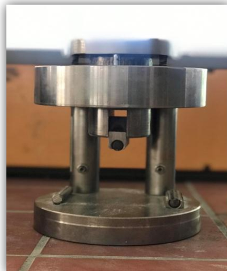
Figure II.15 : dispositif de flexion
