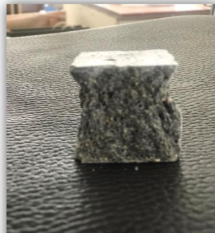
Figure II.18 : Aspect de l'éprouvette après essai de la compression
