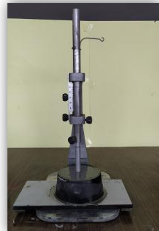
Figure II.1. Appareil de Vicat muni d'une sonde de consistance
