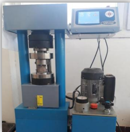
Figure 12 : Presse pour mortier (laboratoire LCTPE).
