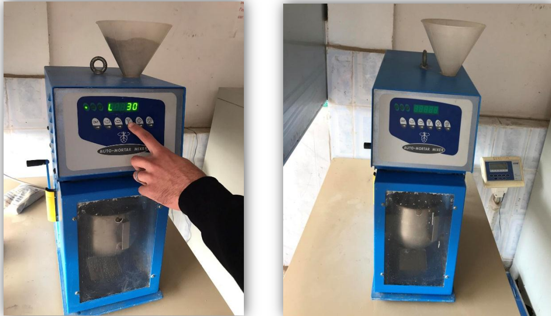
Figure II 4 : Opérations de malaxage des mortiers.
