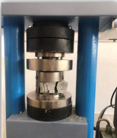
Figure II.17. Rupture de l'éprouvette en compression.
