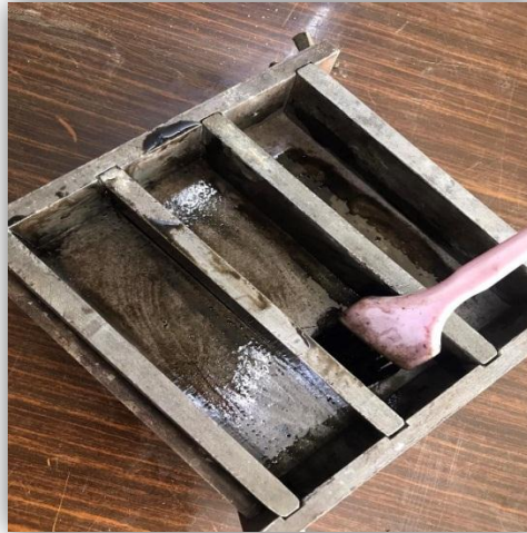
Figure II.7 : Moulage des éprouvettes
