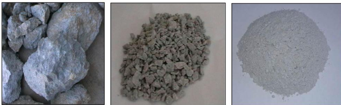
Figure II.3 : Perlite naturelle (a), concassée (b), broyée (c) [31]
