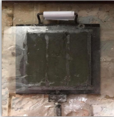
Figure II.8 : Pose d'une plaque en plastique sur le moule
