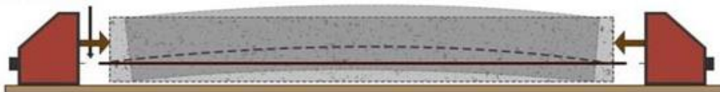
Figure III. 14 : Poutre après mise en tension
