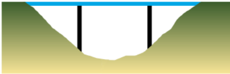
Figure I. 1 : Pont à poutres
