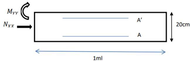
*Figure VI.3 : Section de calcul suivant l'axe y-y.*
