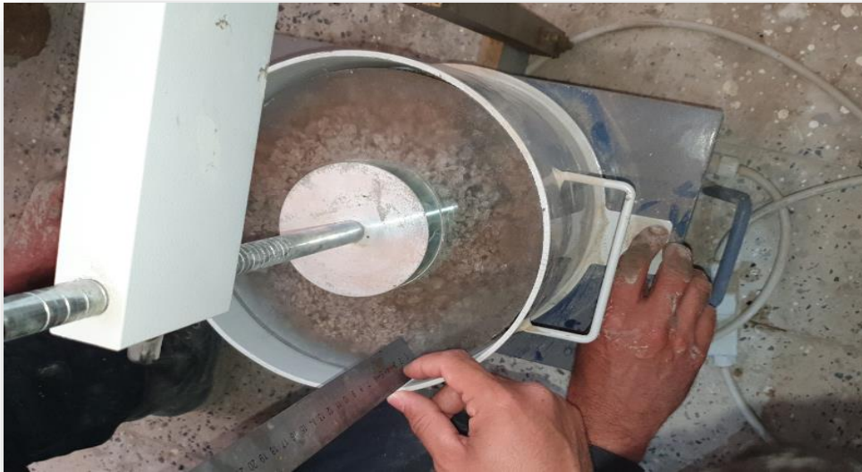
Figure III- 14 : Soulèvement du cône et mesure de l'affaissement A.
