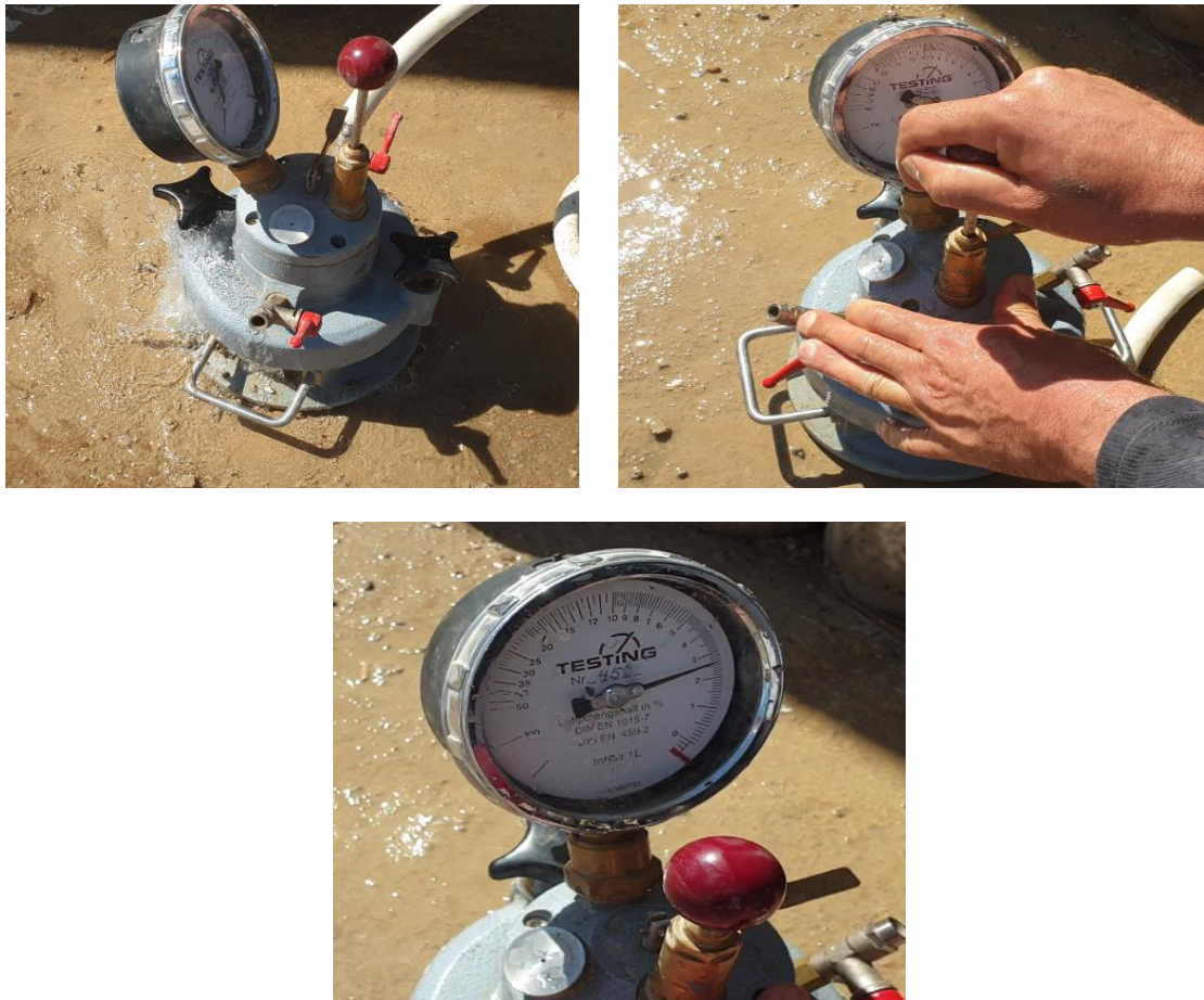
Figure IV- 4 : Essai de la teneur en air.
