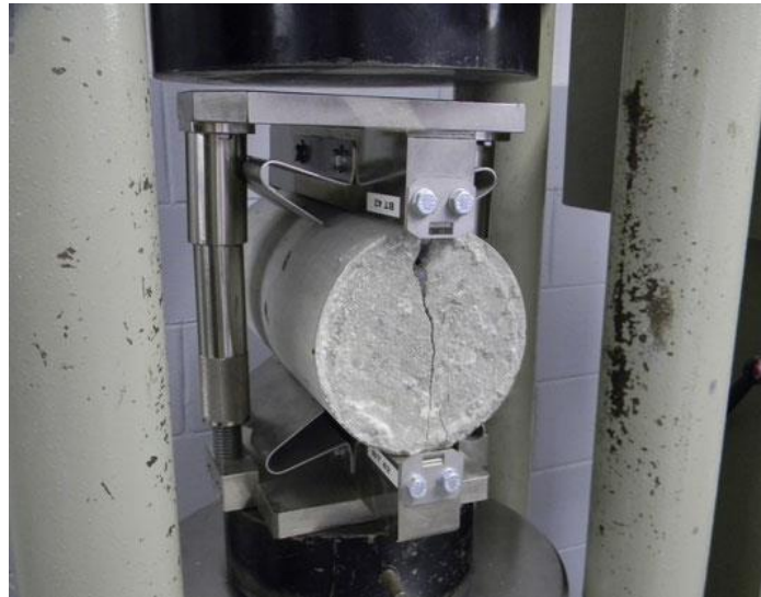
Figure IV- 15 : Essai de traction sur éprouvette de béton désactivé.
