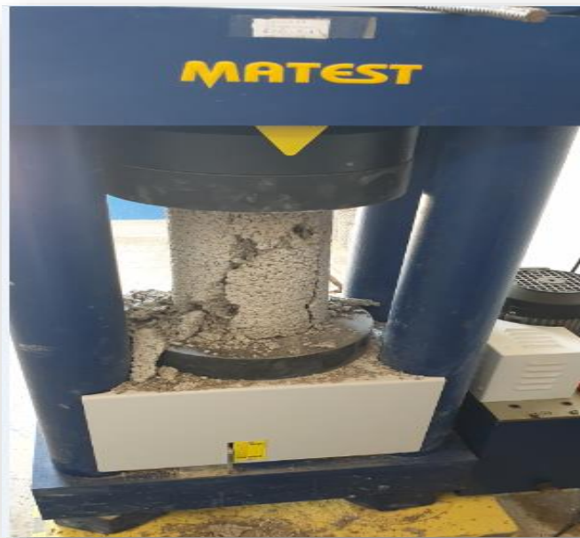
Figure III- 18 : Essai de résistance par compression.
