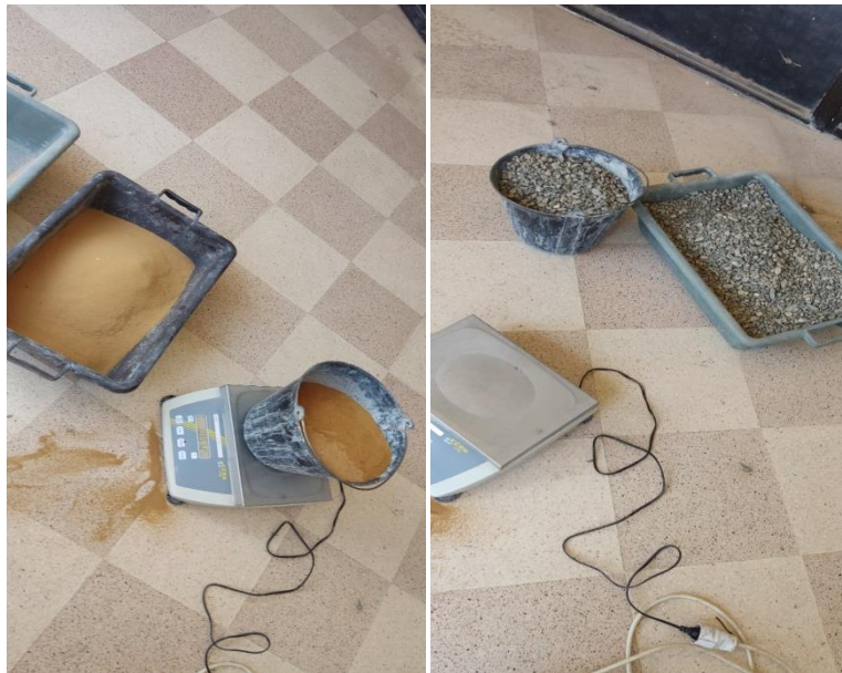
Figure IV- 21 : Préparation et pesage des matériaux.
