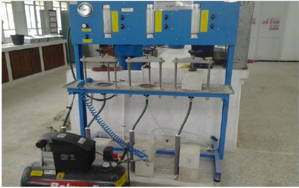
Figure III- 17 : Appareillage de l'essai de perméabilité.
