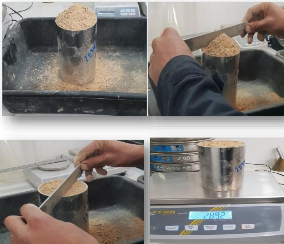
Figure III- 7 : Essai de la masse volumique apparente.
