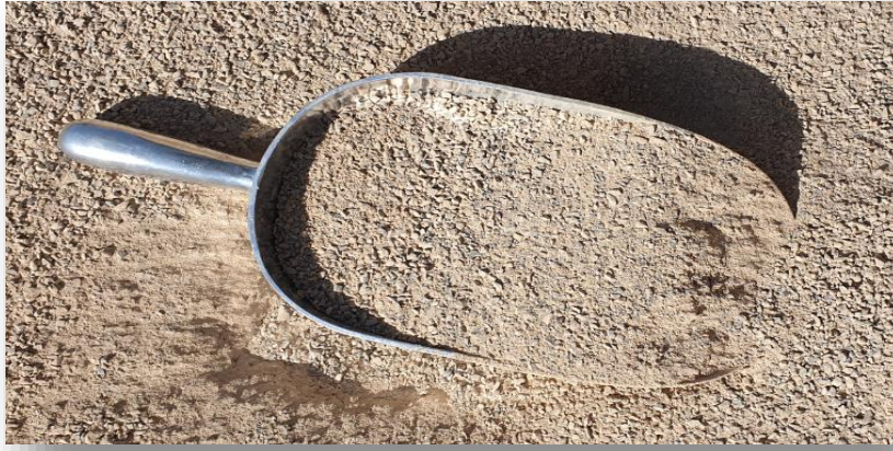
Figure III- 2 : Echantillon de sable carrière sidi abdeli-Sidi Bel ABBES 0/3.
