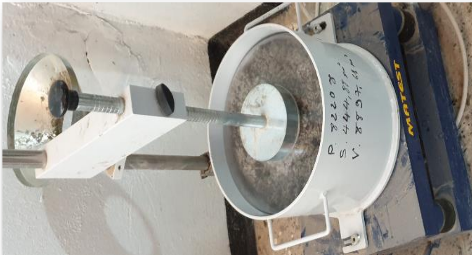
Figure III- 14 : Soulèvement du cône et mesure de l'affaissement A.
