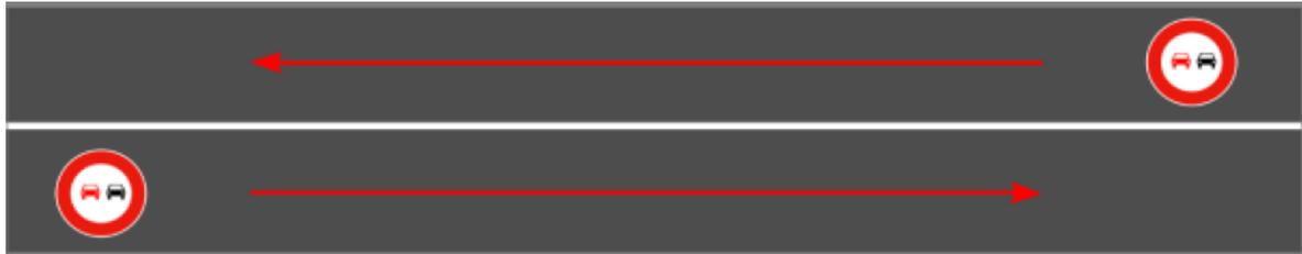
**Figure 23 : Ligne continue interdisant le franchissement ou le chevauchement**
