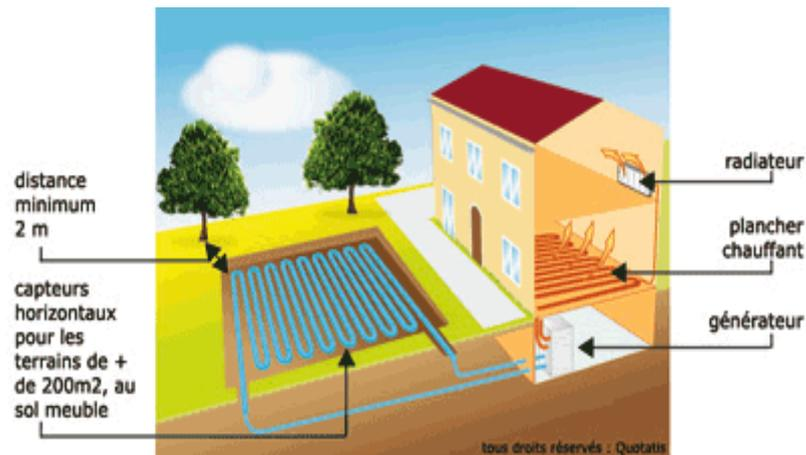
Figure IV. 4: Pompe à chaleur sol / air (Captage horizontal)
