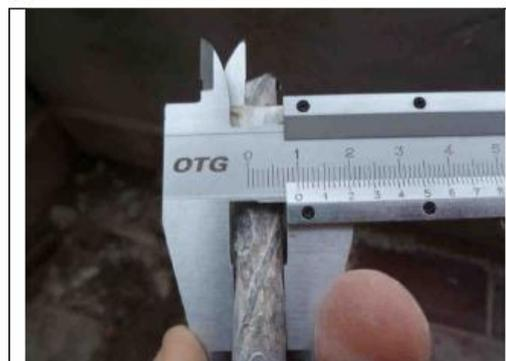
Figure 22: Prélèvement d'aciers
