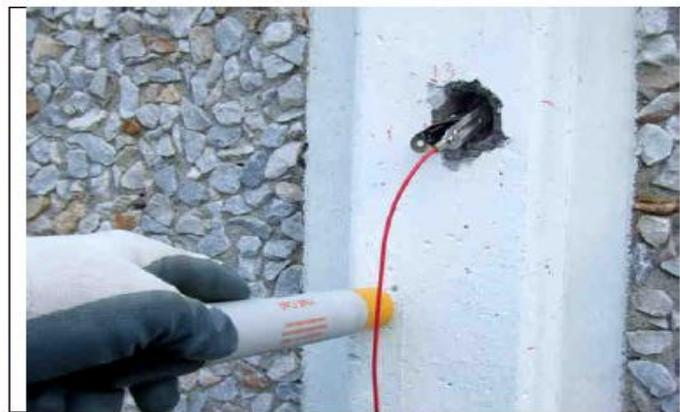
Figure 25: Mesure du potentiel de corrosion
