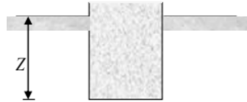
Figure VIII 8 : Encrage de la structure.
