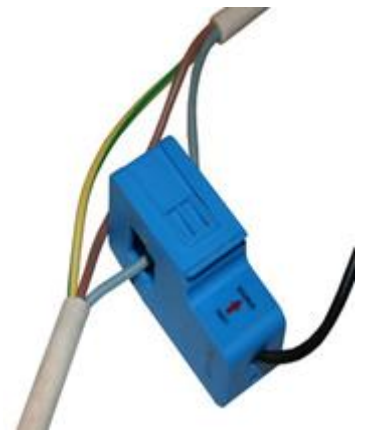
Figure IV-7 : capteur de courant brancher avec une phase
