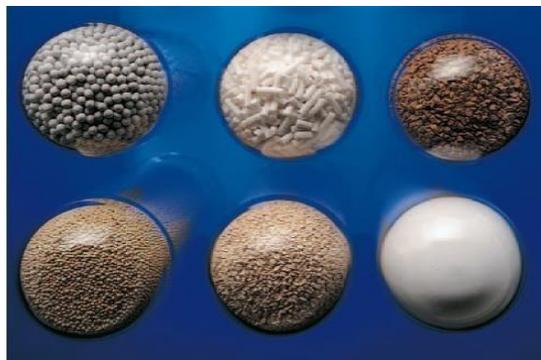
Figure II.8 : Tamis moléculaire sous ses différentes formes
