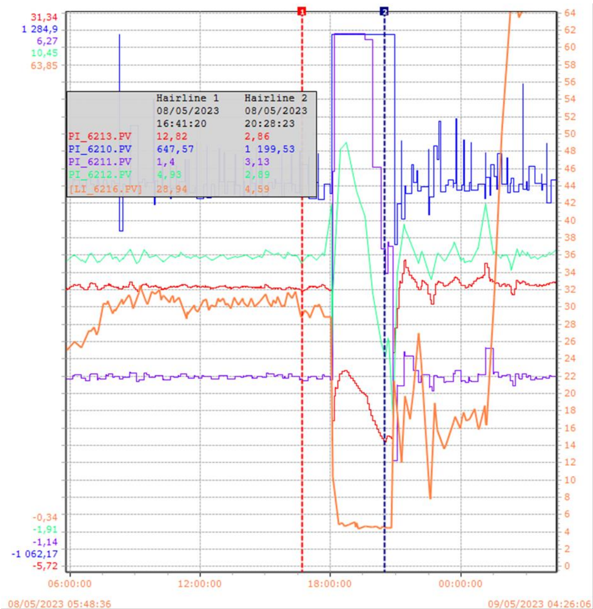
Figure III -13: Les pressions des trois ballons et le refoulement du compresseur avant l'arrêt et au démarrage du TR 600 en 2023
