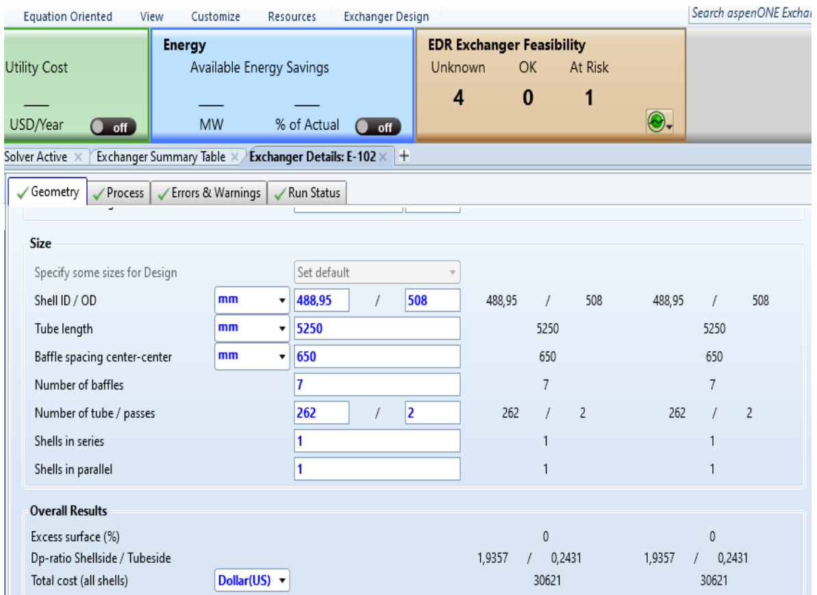
Figure II.13 Géométrie de l'échangeur tube calandre réalisé par Aspen EDR.
