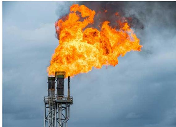
**Figure III.2 :** Combustion incomplète
