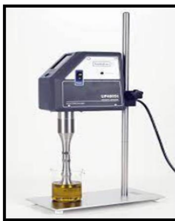
Figure 13 : Extraction par ultrasons (Assami, 2014).
