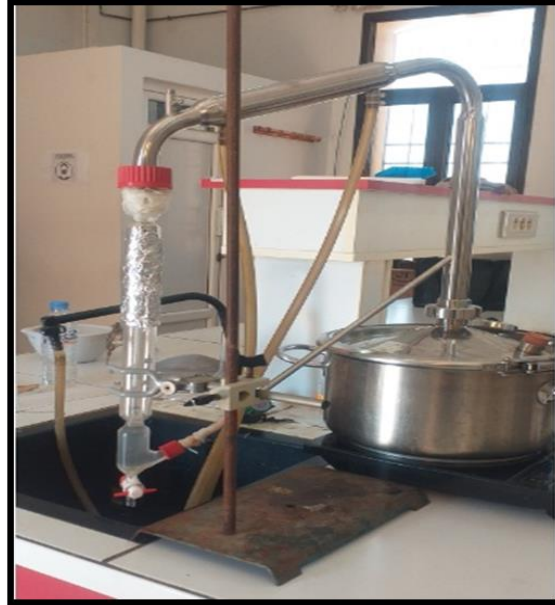
Figure 10 : Schéma de l'appareil d'entraînement à la vapeur d'eau ( Original, 2024 ).
