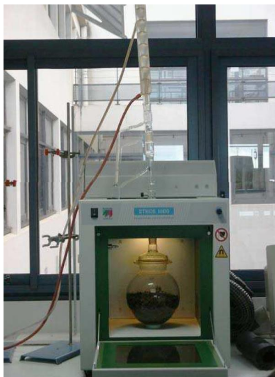
Figure 12 : Schéma du procédé d'extraction d'HE par microondes (Lucc, 2005).
