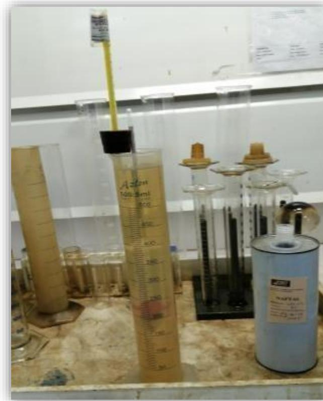
Figure II- 2 : Lecture de la densité utilisant l'aréomètre.
