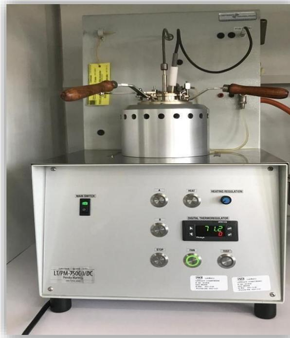
Figure II- 5 : Appareil de mesure du point d'éclair automatique vase close FLASH POINTTESTER HFP 339.
