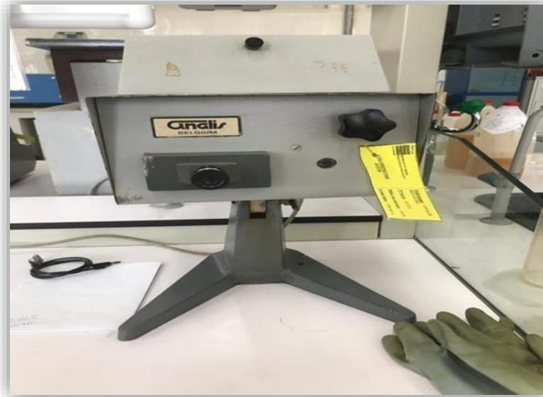
Figure II- 1 : Colorimètre ASTM manuel.
