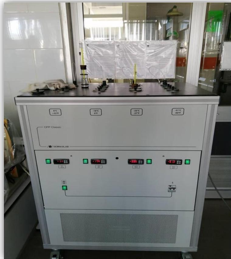
Figure II- 7 : Appareillage de détermination de point d'écoulement par la méthode d'essai ASTM D 97.
