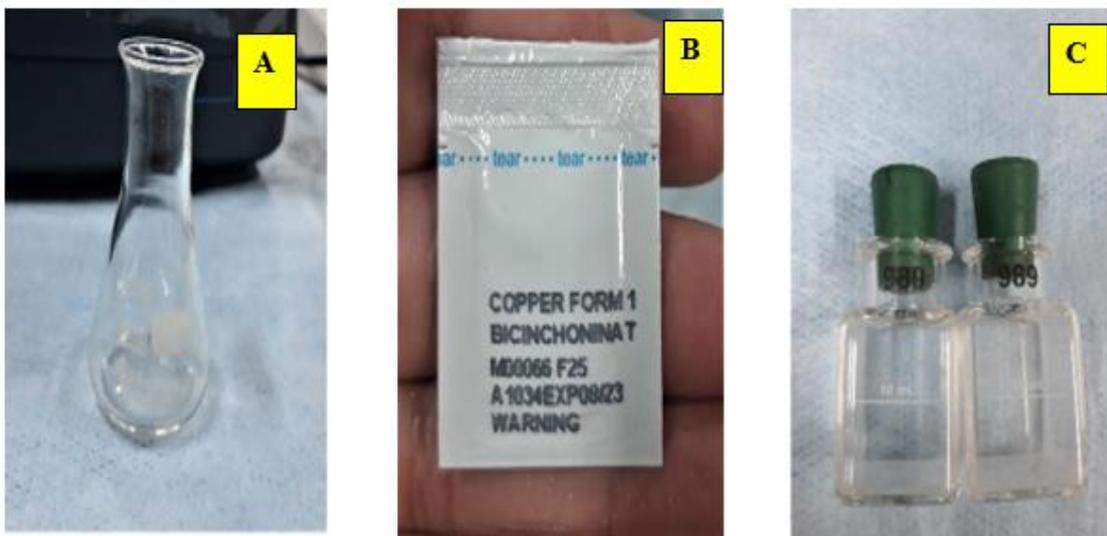
**Figure II-16 :** A) Erlenmeyer ; B) Sachet de réactif de cuivre CAT ;C) : Cuve carrée
