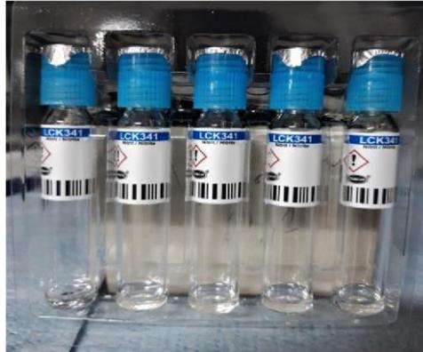
*Figure II-13 : Tube de réactif LCK 341*
