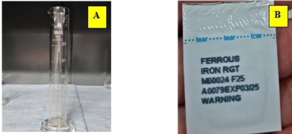
*Figure II-17 : A) Eprouvette ; B) Sachet de réactif de fer CAT 1037769*
