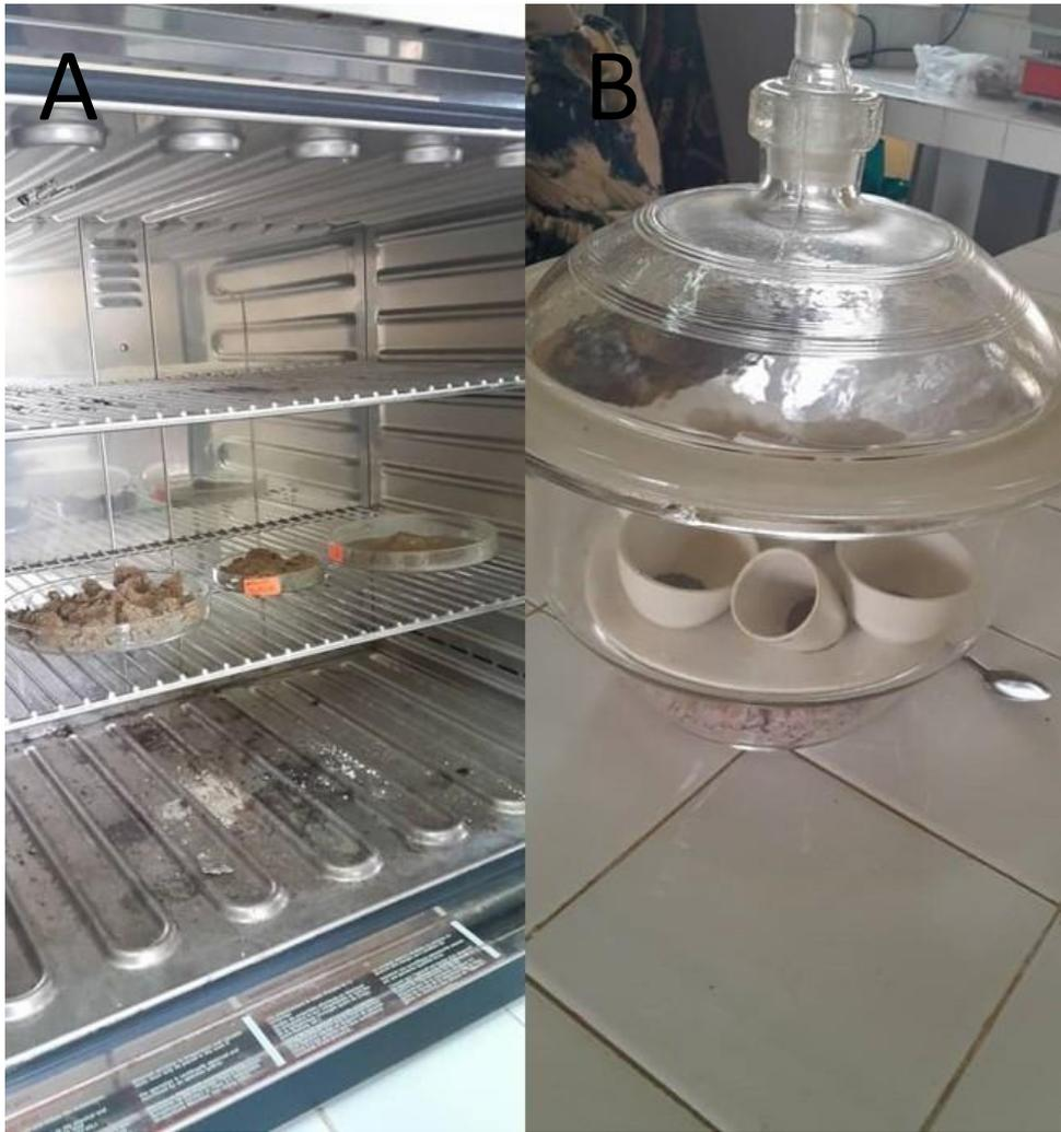
**Figure 15:** (A) : Une étuve a température réglable (B) : Un dessiccateur
