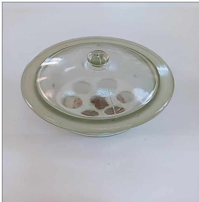
Figure. 16: Echantillon dans le dessiccateur. (Mehidi, 2024).
