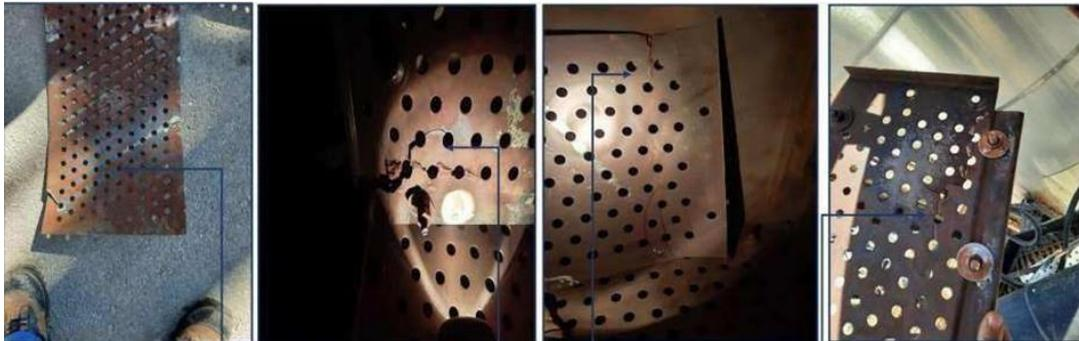
Détachement, fissuration et déformation des plateaux interne de l'équipement 132E.
