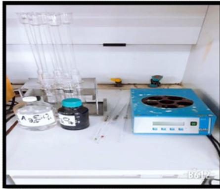
**Figure.III.4** : Analyseur de la DCO.
