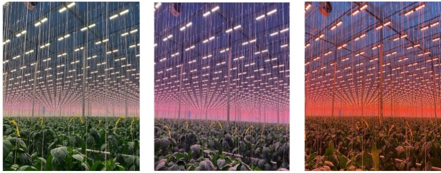
Figure V.11 :Exemple d'éclairage avec des lampes LED
