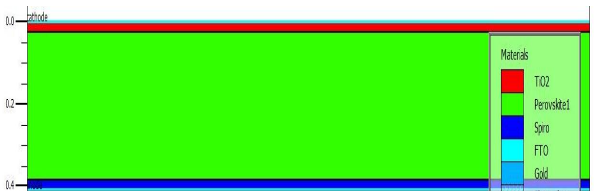
Figure III. 1: Structure obtenue de la cellule solaire à base de la Pérovskite1 simulée sous SILVACO-ATLAS.
