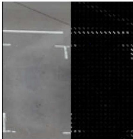
*Figure 33 : Extraction des caractéristiques par le HOG (cellule=4x4) pour une place vide*
