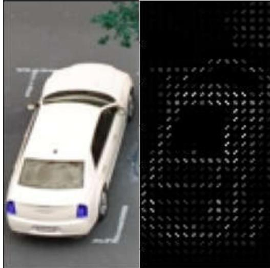
*Figure 32 : Extraction des caractéristiques par le HOG (cellule=4x4) pour une place occupée*
