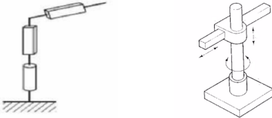
Figure 0.7 : Structure d'un robot cylindrique
