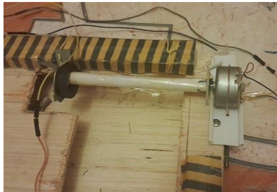
Figure 0.33 : le moteur DC du tapis roulant
