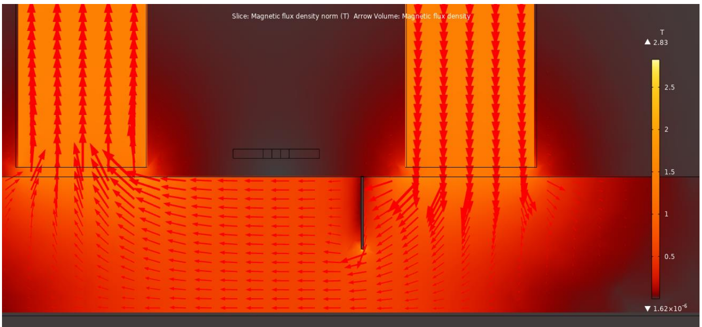
Figure III.57 Affichage zoomé des flèches de flux magnétique dans le cas « Avec défaut »
