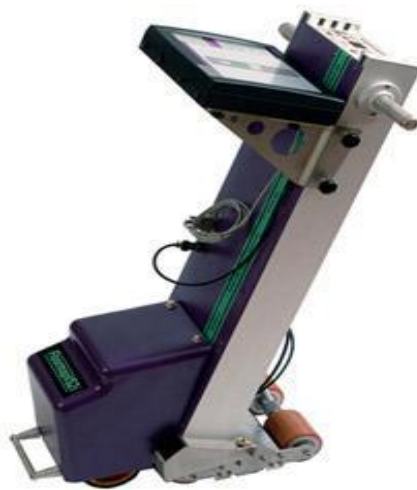
Figure I.9 Photo de l'appareil du CND par flux de fuite magnétique (inspection des plaques)
