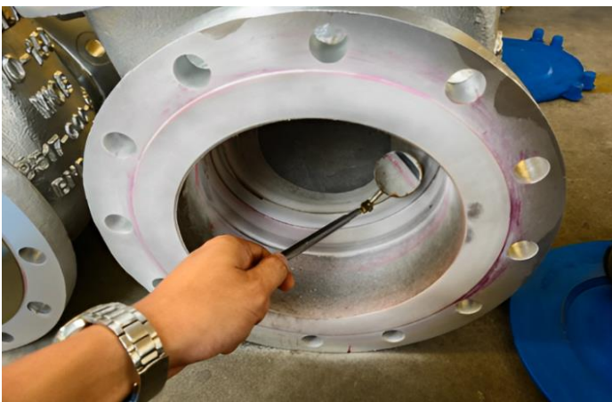
(a) Miroir d'inspection
