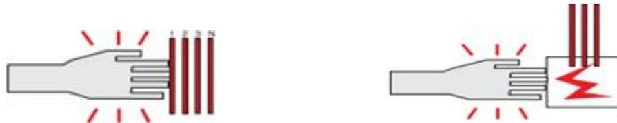
Figure I.6: les types de contacts électriques [4].
