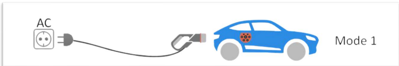
Figure 2-4 : Schéma de recharge en Mode 1 pour véhicules électriques
