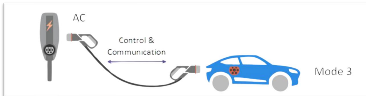
Figure 2-6 : Schéma de recharge en Mode 3 pour véhicules électriques
