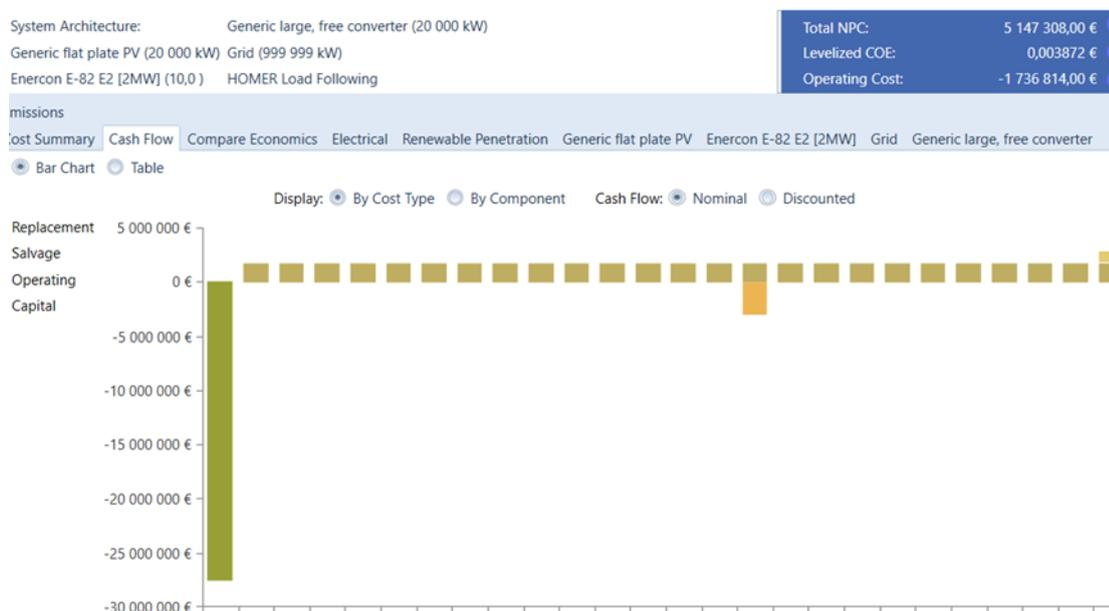
Figure (III.44) : Résumé des opérations et des remplacements pendant toute la durée de fonctionnement du système.
