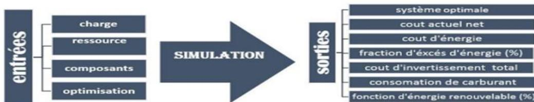
Figure (III .1) : Schéma de l'architecture de simulation de Homer.
