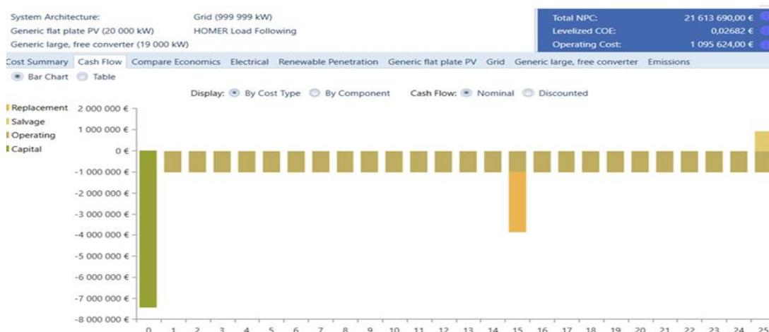
Figure (III.30): Résumé des opérations et des remplacements pendant toute la durée de fonctionnement du système
