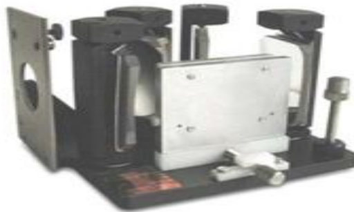
Figure III.6. Système ATR Vertical '25-R' à angle d'incidence variable.
