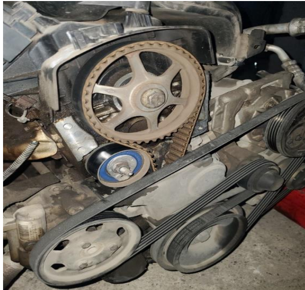
Figure II-5: photo prise du système de distribution du Moteur RENAULT CLIO COMPUS 1.2 16V
