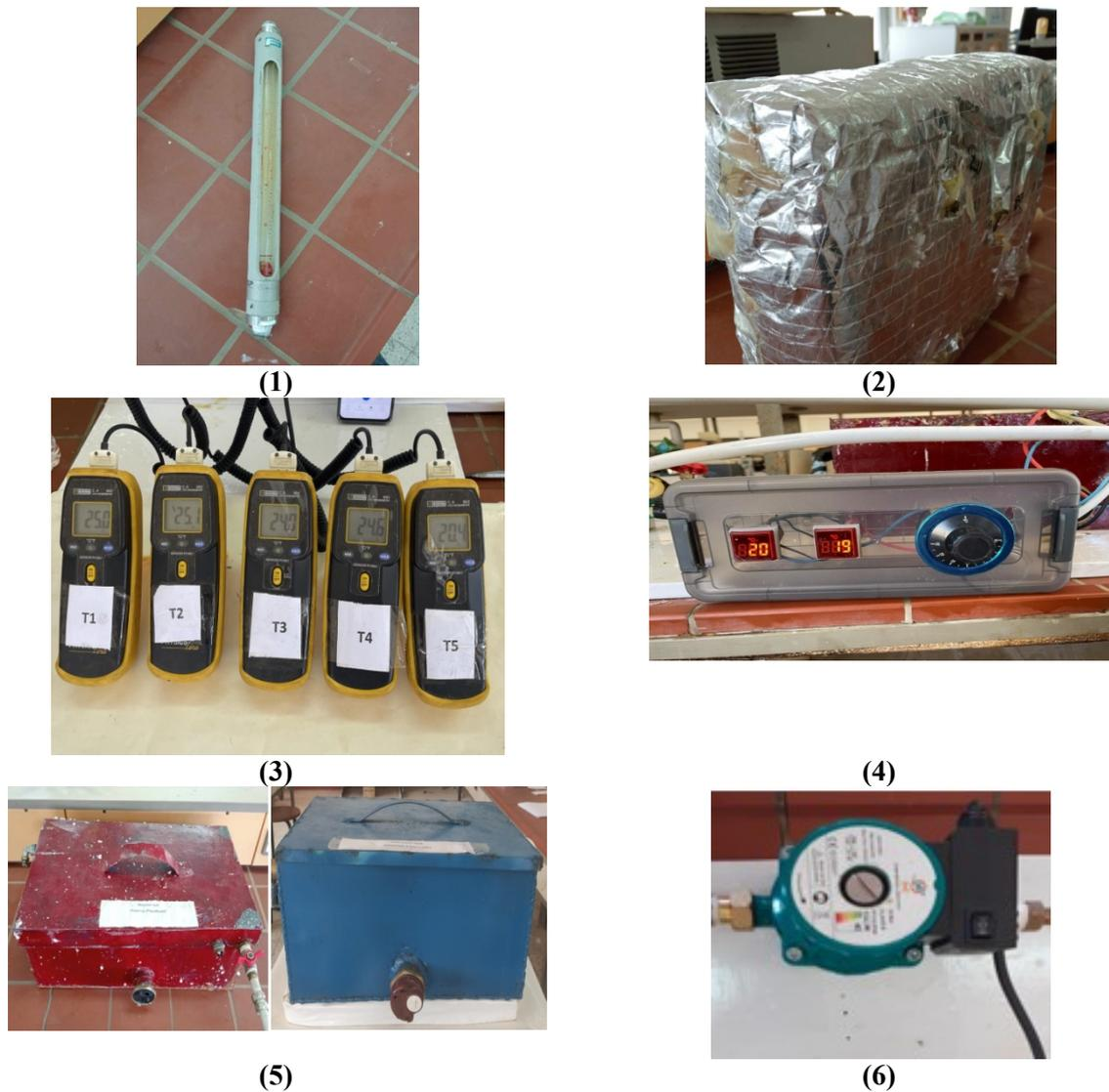
**Figure 3.2:** Matériel et accessoires de l'installation : 1) Débitmètre, 2) isolant, 3) les capteurs des températures, 4) régulateur de résistance, e) Réservoir de l'eau chaude et l'eau froide et 6) pompe.
