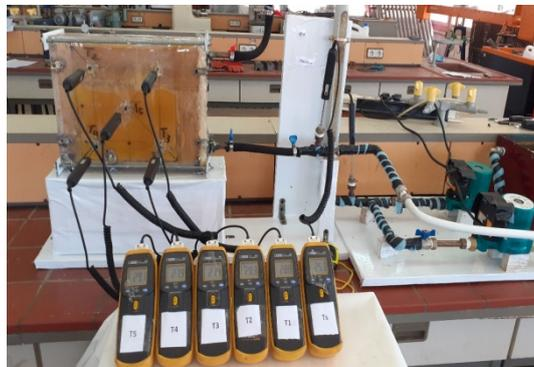
**Figure 4.2 :** Configurations d'injection possibles durant les essais (Sections d'essai rempli de la cire d'abeille).
