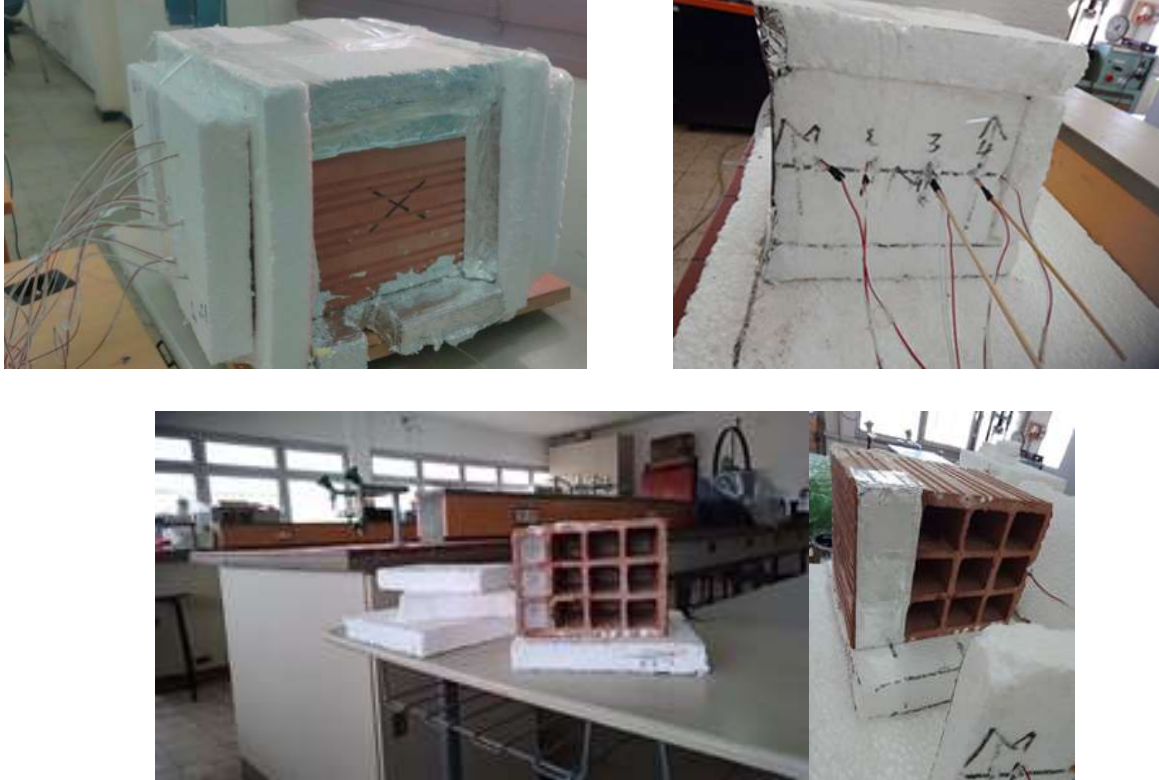
Figure 3.3 : Les composants de Section d'essais
