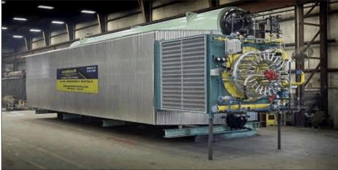
**Figure IV.4 :** Chaudière à tubes d'eau
