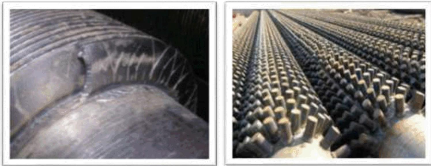
**Figure III.17 :** Tubes avec des ailettes
