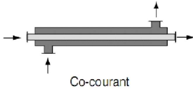
Figure II-2 Echangeur de chaleur à double tube à co-courant
