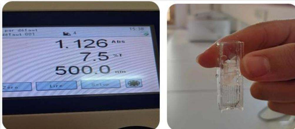
**Figure 33** : Le résultat d'opacité du bioplastique d'amidon de maïs renforcé par gélatine dans le spectrophotomètre.
