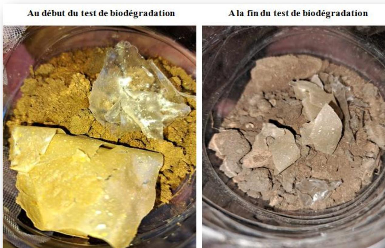
**Figure 31 :** L'état de bioplastique à base d'amidon de maïs et bioplastique à base d'amidon de maïs renforcé par l'argile au début et à la fin du test de biodégradabilité.
