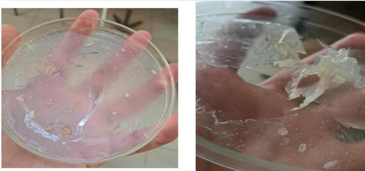
**Figure 23 :** Bioplastique fabriqué à base d'amidon de maïs renforcé par la gélatine.
