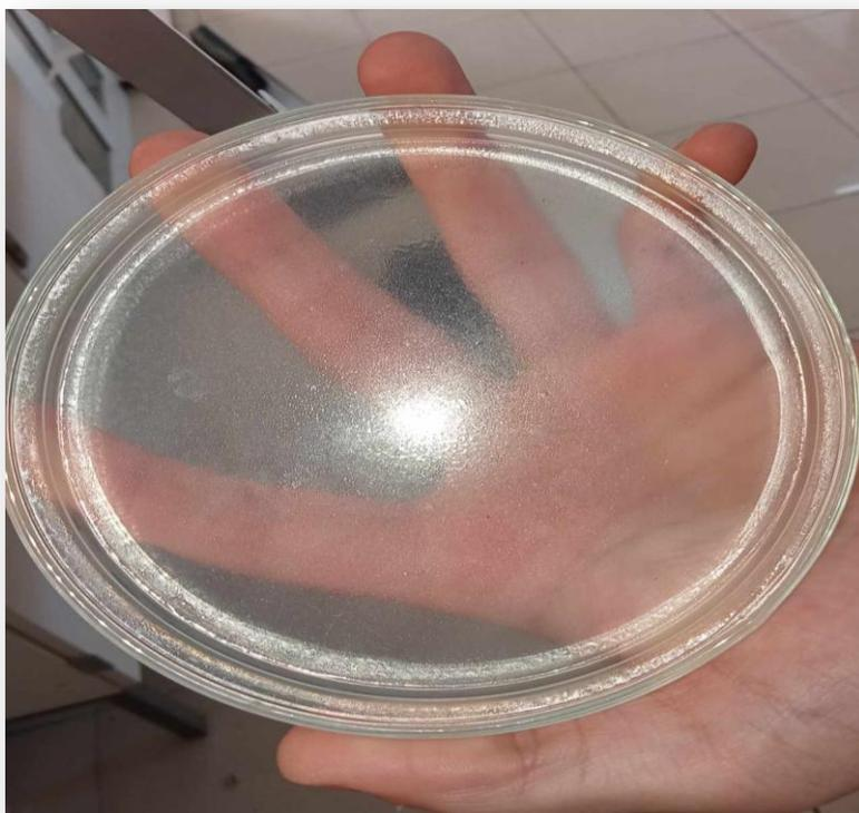
**Figure 17** : Un bioplastique fabriqué à base d'amidon de maïs.
