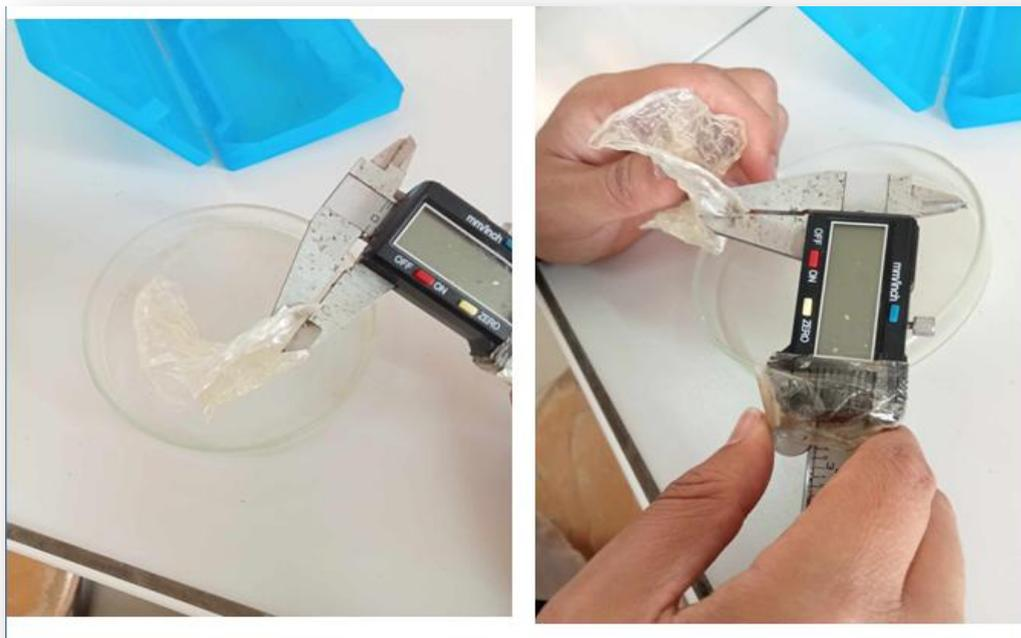
**Figure 32 :** Des échantillons de bioplastique à base d'amidon de maïs renforcé par l'argile et non renforcé avant de mettre dans l'étuve.
