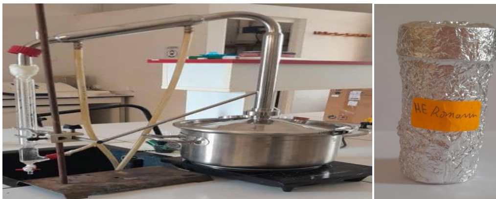
Figure 15 : Hydrodistillateur de type Clevenger pour l'extraction de l'huile essentielle de Rosmarinis Officinalis (laboratoire de Biochimie N°01 au niveau de faculté SNV université Abdelhamid Ibn Badis Mostaganem) et les huiles essentielles de Rosmarinus officinalis (Photos personnelle, 2024).
