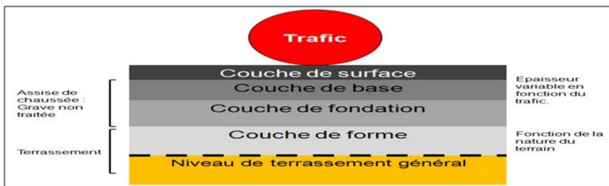
**Figure VII.1 :** Structure type d'une chaussée souple.
