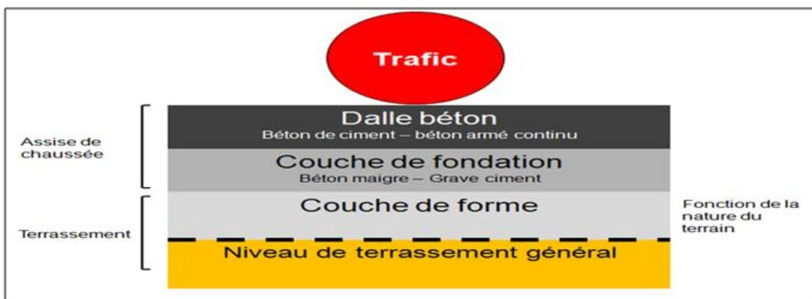
Figure VII.3 : Structure type d'une chaussée rigide.
