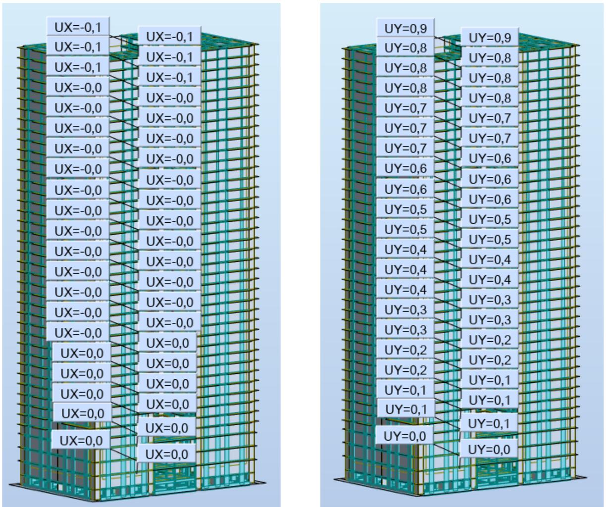
Figure IV-12 : Déplacement suivant x et y du bâtiment
