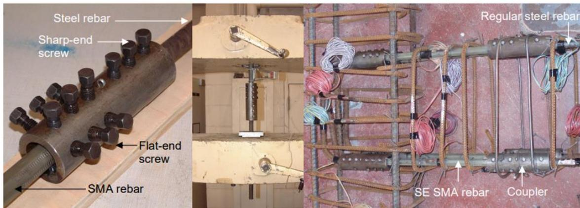
**Figure3. 16.** Assemblage poteau poutre avec AMF à l'état réel [7]
