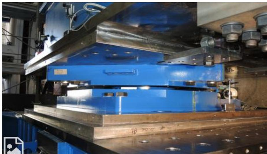
**Figure2. 8.** Utilisation du contrôle passif dans la grande mosquée d'Alger[14]
