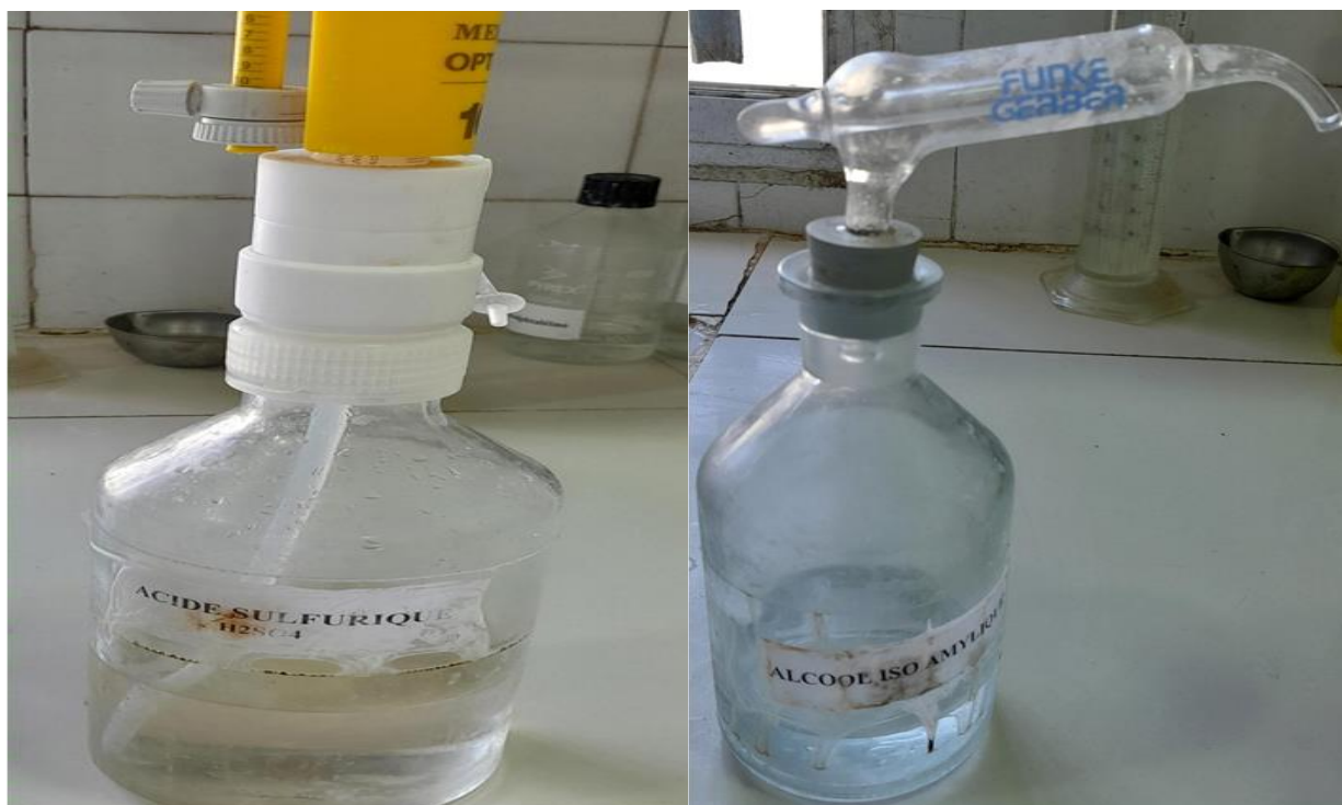
Figure 18: Acide sulfurique et l'alcool utilisés pour la mesure de la matière grasse .
