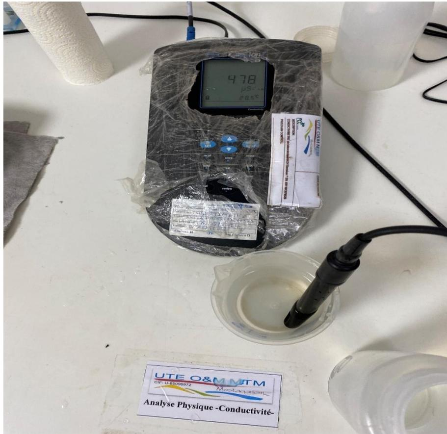
**Figure 22.** Conductivimètre de la station de Mostaganem
