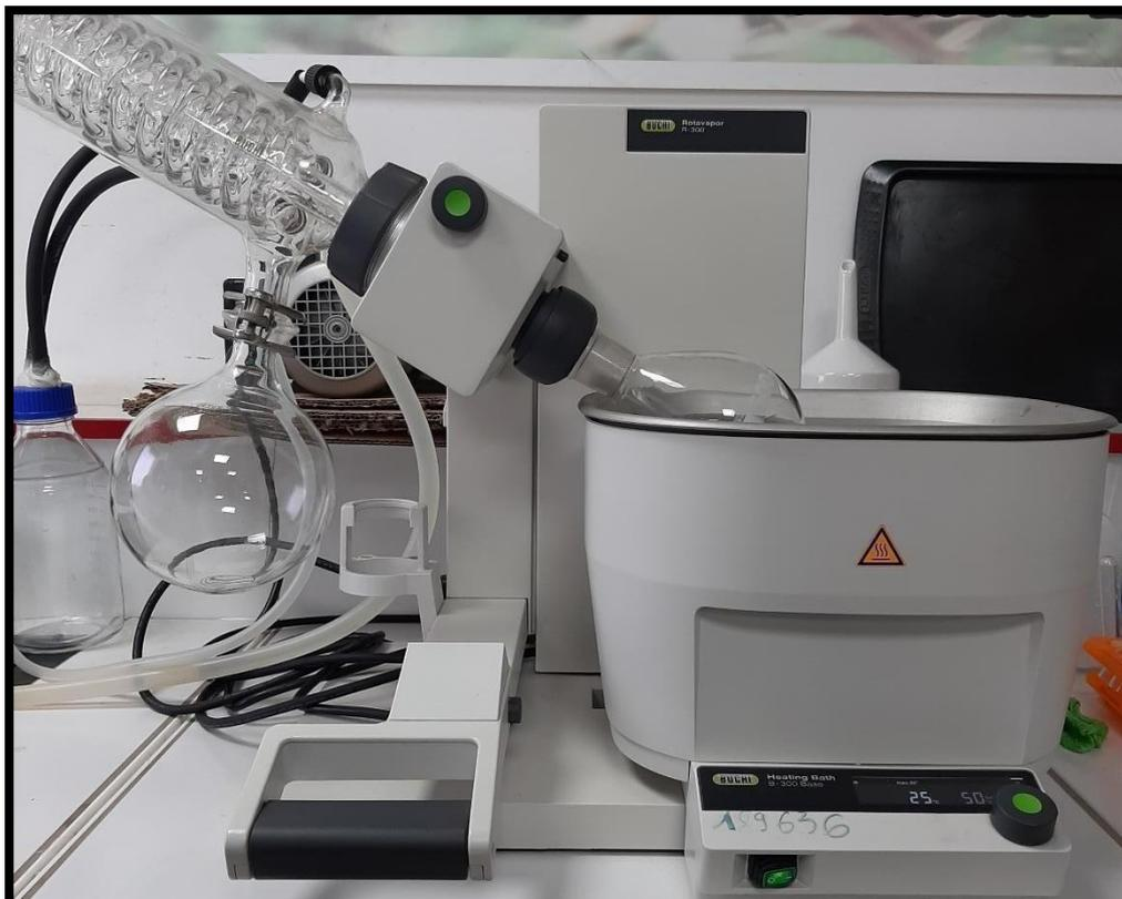
Figure 10 : L'évaporateur rotatif.
