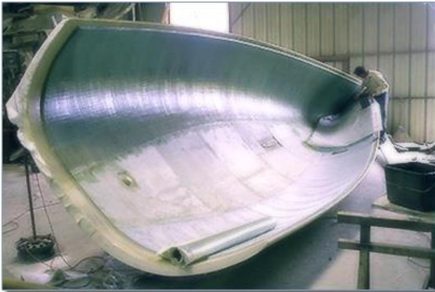
Figure 24 : Fabrication de coque de bateau a l'aide des matériaux composite
