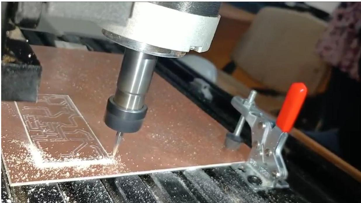
Figure III- 24: La gravure avec le logiciel GRBL Contrôle sur la machine
