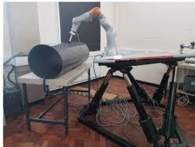
Figure II. 9: Bras manipulateur fixé sur la plateforme mobile pour assurer la soudure des pipelines [19].
